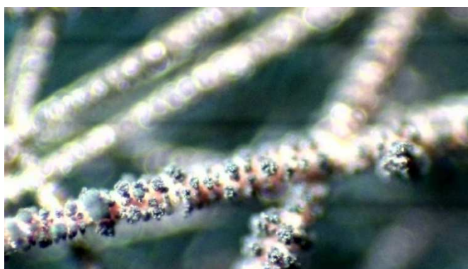
Рис. 3. Углеволоконистая вуаль с электрохимически нанесенным Fe и Ni под микроскопом
