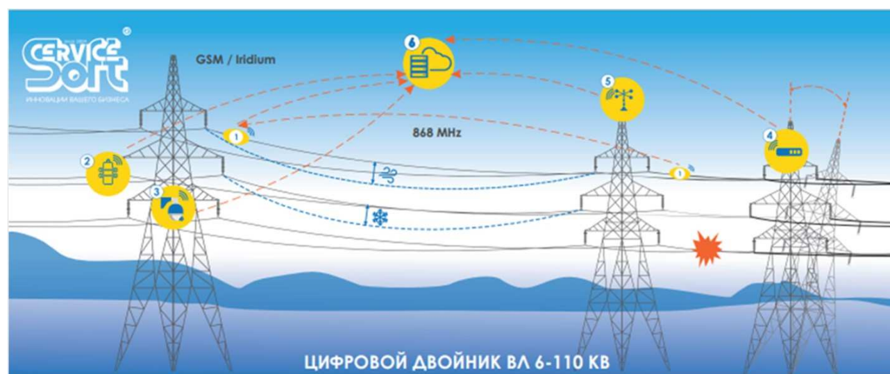
Рис.1. Цифровой двойник ВЛ 6-110 кВ, где 1 – модуль дистанционной диагностики проводов ВЛ; 2 – модуль дистанционной диагностики изоляторов ВЛ; 3 – охранный модуль ВЛ; 4 – модуль дистанционной диагностики опор ВЛ; 5 – метеостанция ВЛ; 6 – сервер диспетчерского центра электросетевой компании
